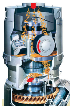
Beispiel einer Pelletpresse und die Übersicht einer Pelletanlage
